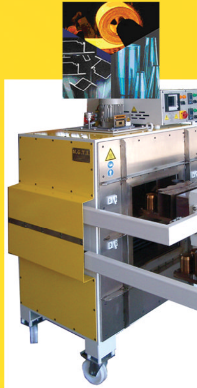
LADENOFEN (Duo) Vorwärmmofen für Zylinderbuchsen Temperaturbereich 500 °C Temperaturgenauigkeit 2 K
