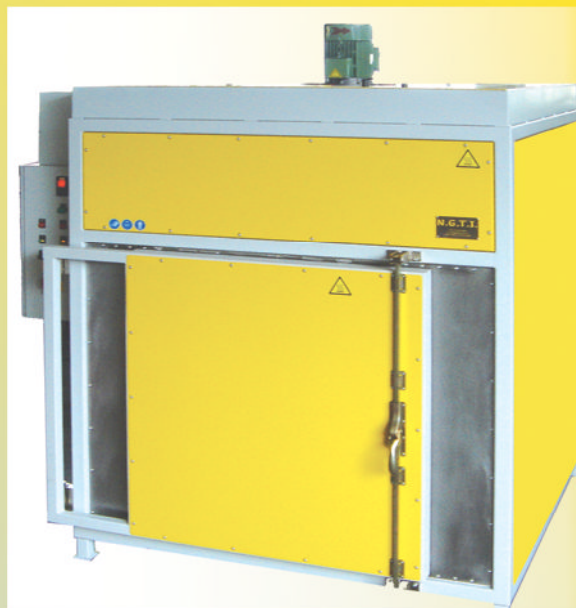
KAMMEROFEN Lösungsglühen und Warmauslagern von Aluminiumteilen Temperaturbereich 650 °C Temperaturgenauigkeit 2 K
