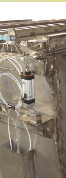
MEHRFACH KAMMEROFEN Top loading Tempern und Härten von Aluminiumteilen Temperaturbereich 300 °C Temperaturgenauigkeit 2 K
