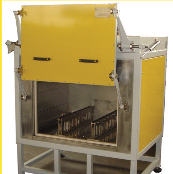
KAMMEROFEN Vorwärmmofen für Spritzgusswerkzeuge (1.000 kg) Temperaturbereich 250 °C Temperaturgenauigkeit 2 K
